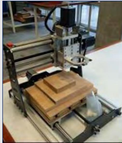
Fig. 4 Centro de mecanizado de control numérico
