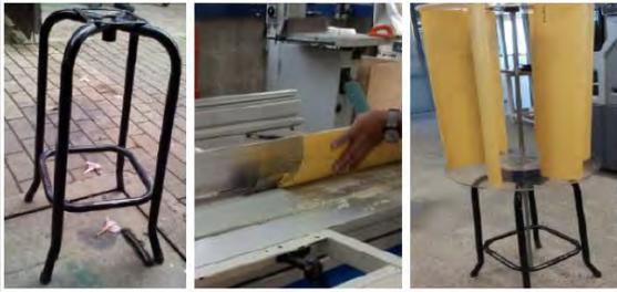
Figura 6. Proceso de fabricación del aerogenerador
