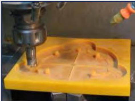
Imagen 9. Fabricación del prototipo para el mouse para discapacidad motriz fina en el Centro de Maquinado Vertical CNC del Laboratorio.
